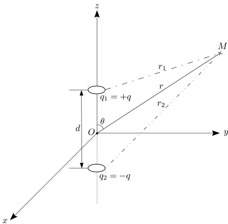
FIGURE 2 – Dipôle électrostatique.
