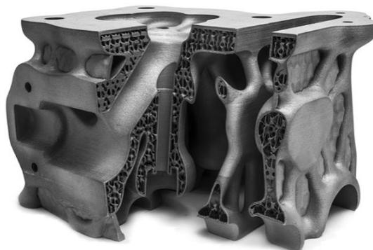
Figure 5. Concept de culasse de F1 réalisée sous LBM (Inovar Communications Ltd, 2016)
