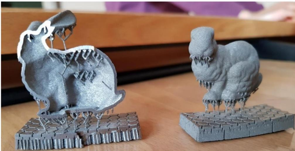
Figure 33. Exemple de support lattice réalisé par optimisation lors de la conception (Vaissier *et al.*, 2019)
