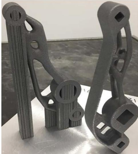
Figure 32. Astuces pour diminuer les supports et défauts géométriques. Comparaison entre la pièce obtenue par optimisation topologique (à gauche) et la pièce ayant subi en plus des modifications suivant les règles de tracé adaptées au procédé LBM pour diminuer les supports et le post traitement (à droite). (Saunders, 2017)
