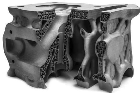
Concept de culasse de F1 réalisée sous LBM
