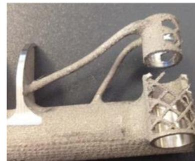
Destruction de la pièce lors du post-traitement par usinage. Adapté de (Doutre, 2015; Hoang et al., 2015)
