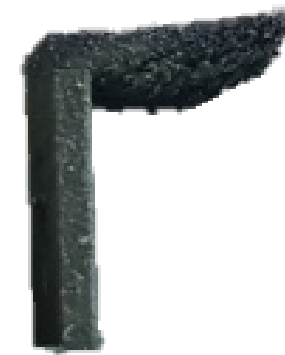
Scorie lors d'impression de porte à faux (Imprimé sous L-PBF par MAQ-3D)
