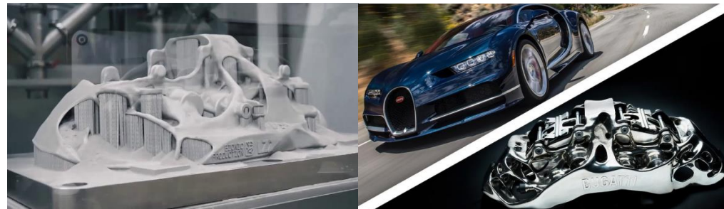
Exemple pour la technologie L-PBF: Enlèvement du support, usinage et traitement de surface
