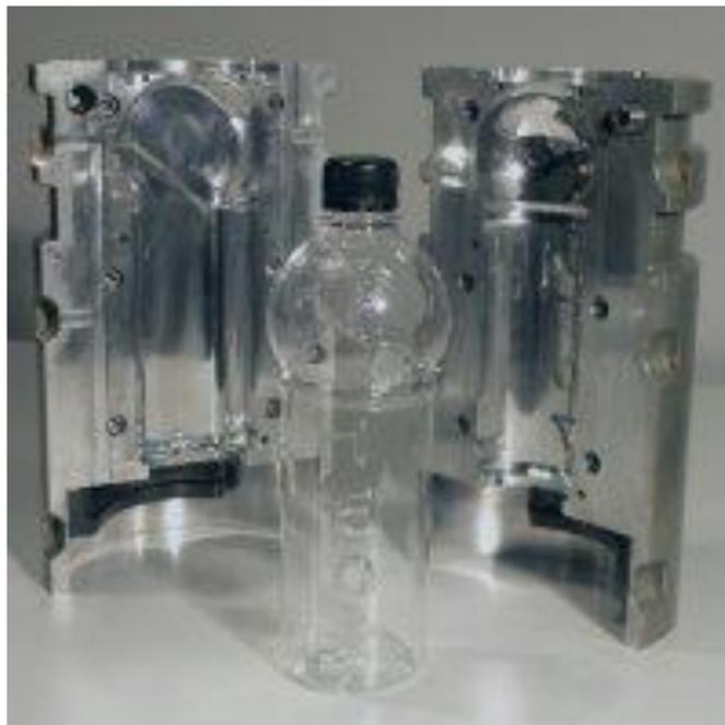
Figure 29 : Moule pour injection soufflage « Végétal Minéral Water ». Source <http://www.stratoconception.com>
