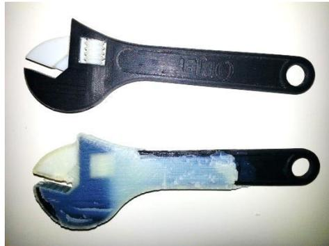
Figure 37 : Exemple d'une clef à molette sans puis avec le support partiellement enlevé à la main
