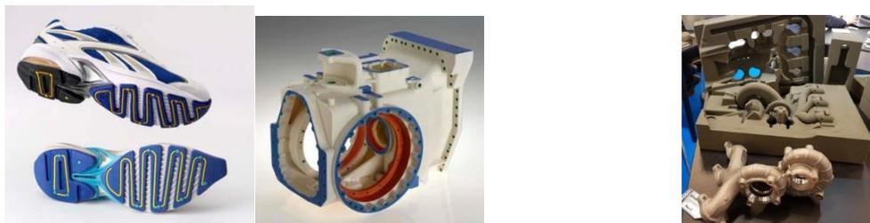
Figure 35 : Prototype de chaussure et de carter Source : <http://www.zcorp.com> ; Moule et noyaux
