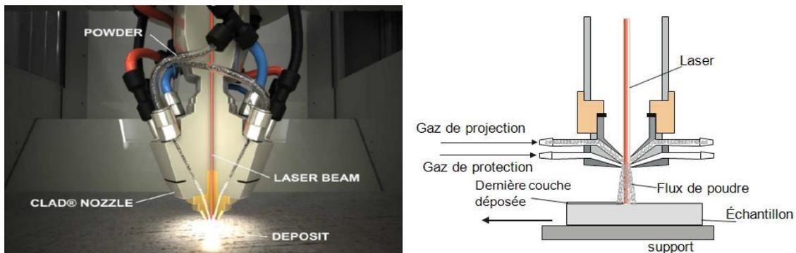
Figure 17 : Vue en écorchée d'une tête de projection CLAD (à gauche) Principe du procédé (à droite). Source : dma-laser.fr
