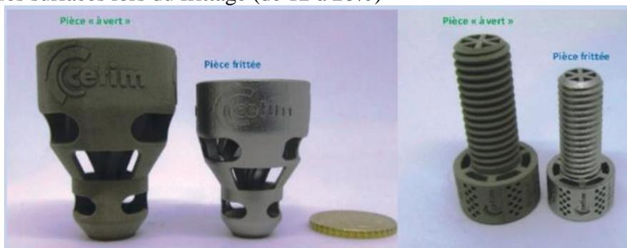
Figure 27 : Exemples de pièces réalisées par MBJ avant et après frittage
