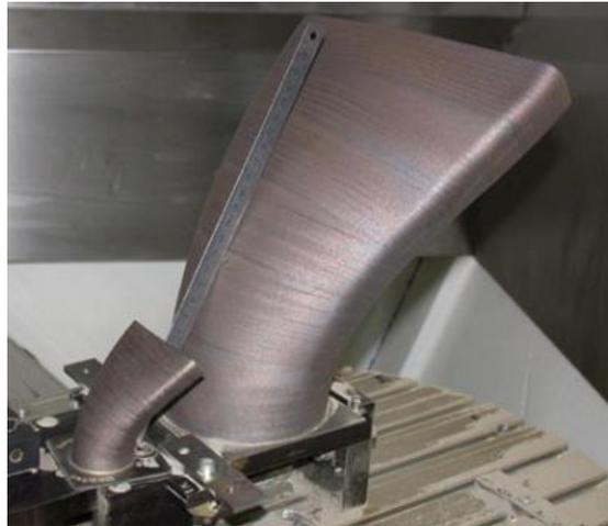
Figure 19 : Conduits aéronautiques obtenus par projection de poudres (Le Bourhis, 2014)
