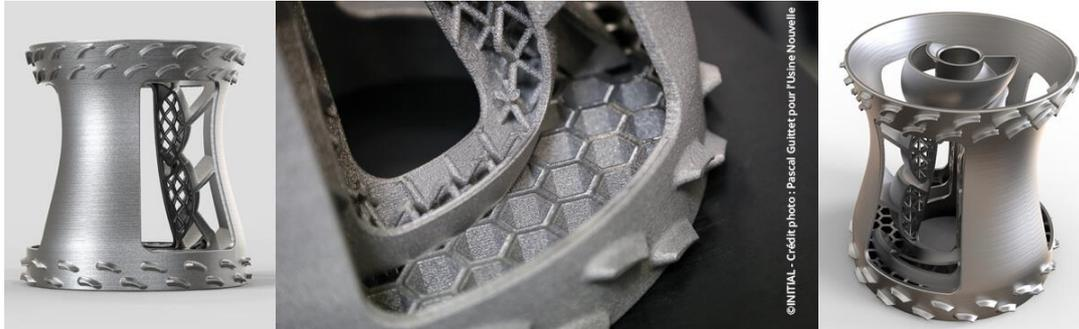
Figure 16 : Corps de refroidisseur réalisé par EBM
