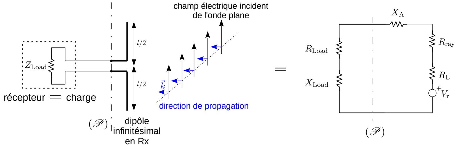
La surface efficace (ou surface équivalente, aire d'absorption, aire effective) est définie comme le rapport de la puissance fournie (ou transmise) à la charge à la densité de puissance de l'onde incidente
