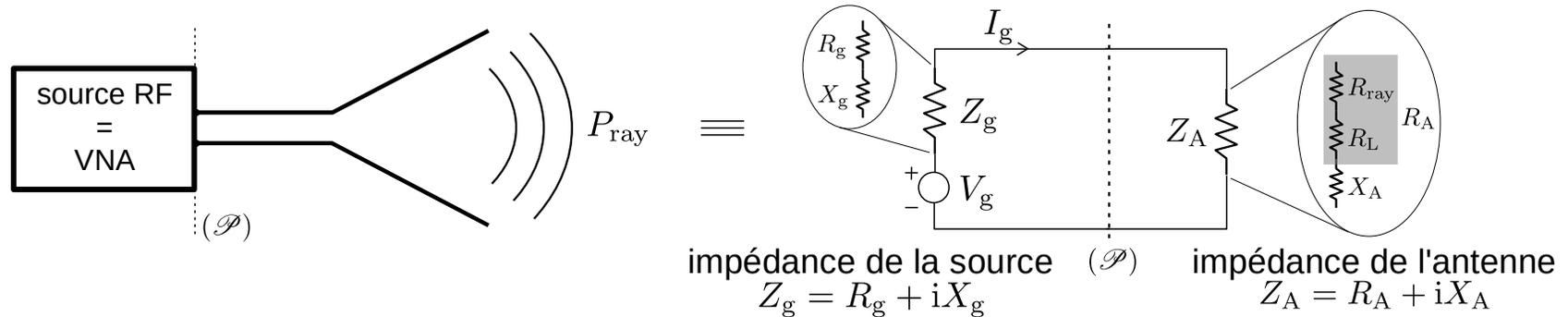
$$\text{courant fourni par la source } I_g = \frac{V_g}{Z_A + Z_g} = \frac{V_g}{R_g + R_L + R_{\text{ray}} + i(X_A + X_g)}$$
