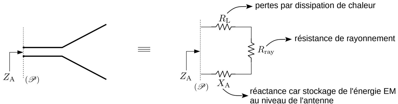
$$Z_A = R_A + iX_A \quad \text{avec} \quad \begin{cases} R_A = R_{\text{ray}} + R_L \in \mathbb{R}_{>0} \\ X_A \in \mathbb{R} \end{cases}$$
