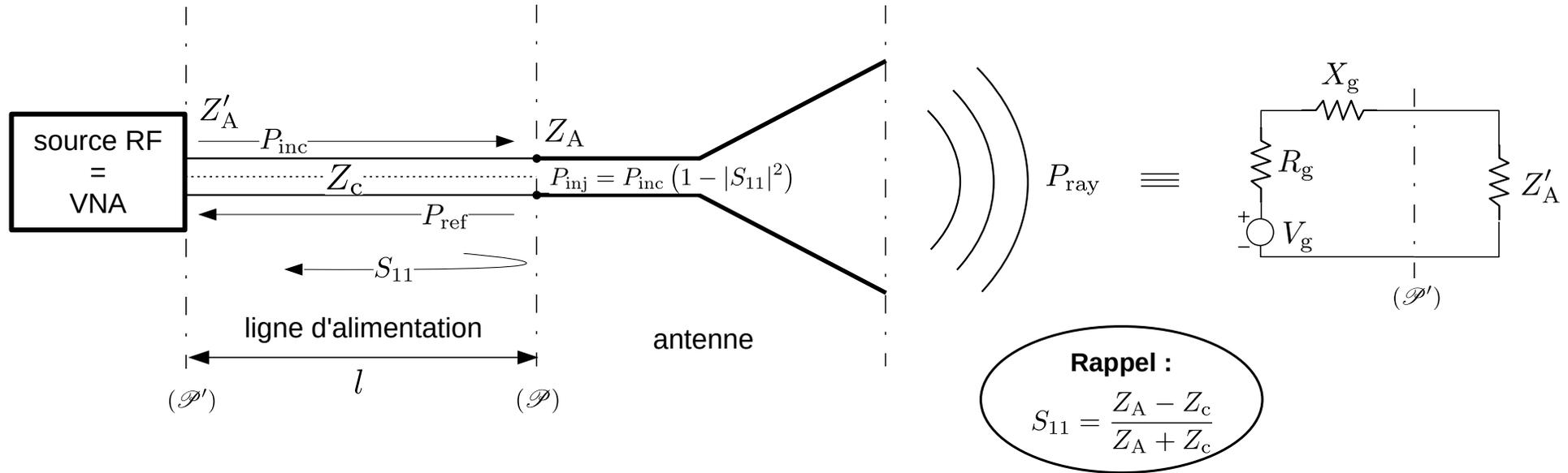
Pour une ligne à pertes, l'impédance de l'antenne ramenée par la ligne en sortie de la source (ou à l'entrée de la ligne) est
