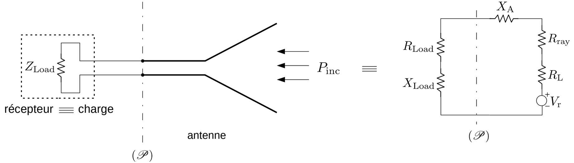
En Rx, l'onde incidente captée par l'antenne peut être modélisée par une source de tension  $V_r$  analogue à la source  $V_g$  du fonctionnement en Tx.
