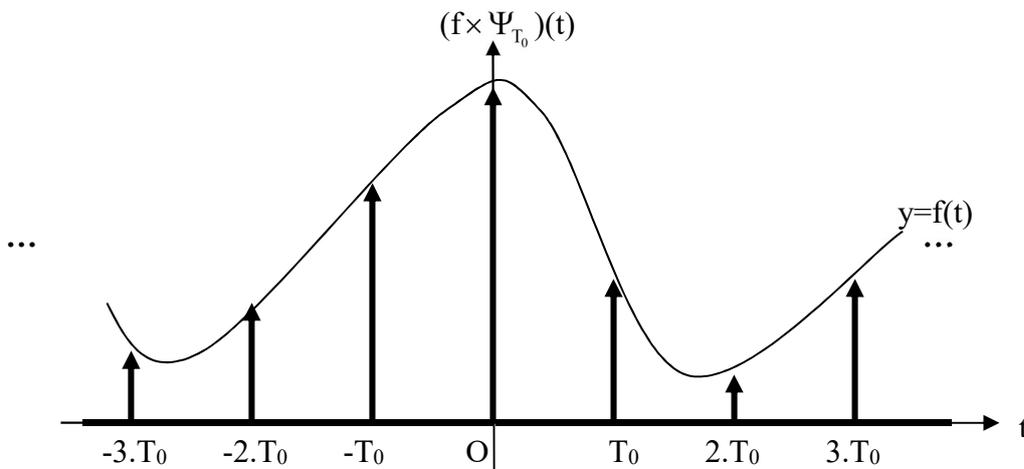
On obtient ici l'echantillonnage du signal f a la periode  $T_0$ .
