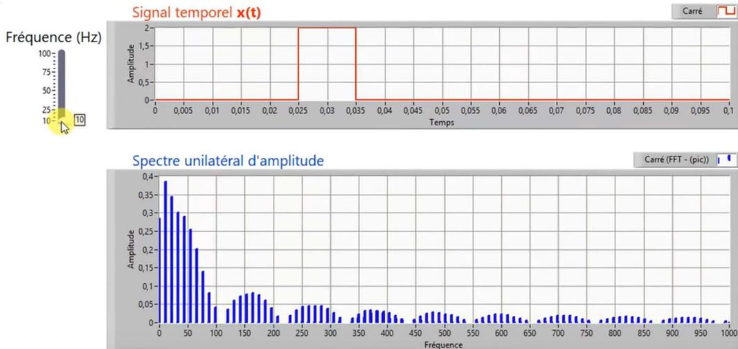
**Partie B : Analyse spectrale d'un signal apériodique – Transformation de Fourier**
