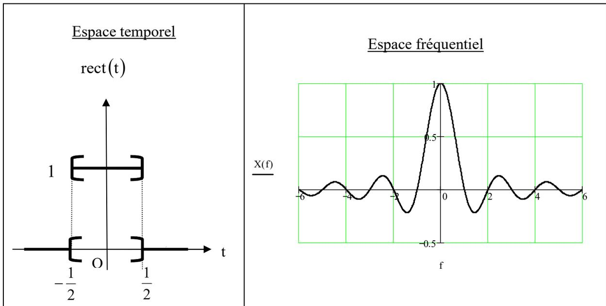
Spectre d'amplitude Tracer dans l'espace fréquentiel le spectre d'amplitude du signal rectangle. Il s'agit d'un spectre symétrique par rapport à la fréquence nulle.
