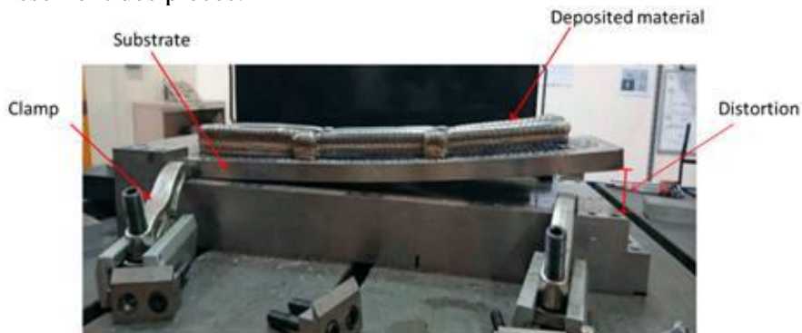
Figure 22 : Problème de gauchissement pour le WAAM (source : metalblog.ctif.com)
