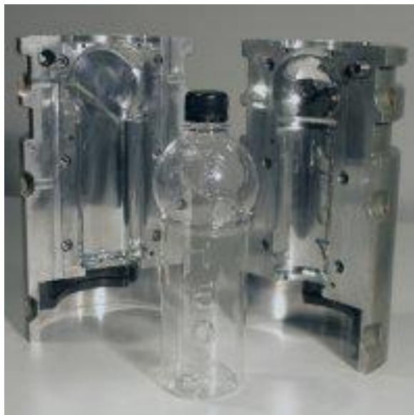
Figure 35 : Moule pour injection soufflage « Végétal Minéral Water ». Source http://www.stratoconception.com
