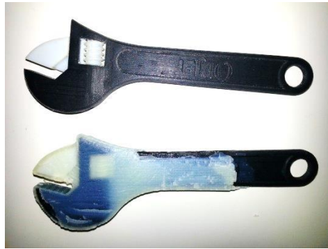
Figure 45 : Exemple d'une clef à molette sans puis avec le support partiellement enlevé à la main
