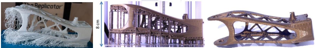
Figure 38 : Exemple de nécessité de support, réalisation de la pièce. Source : (Lefebvre 2015)
