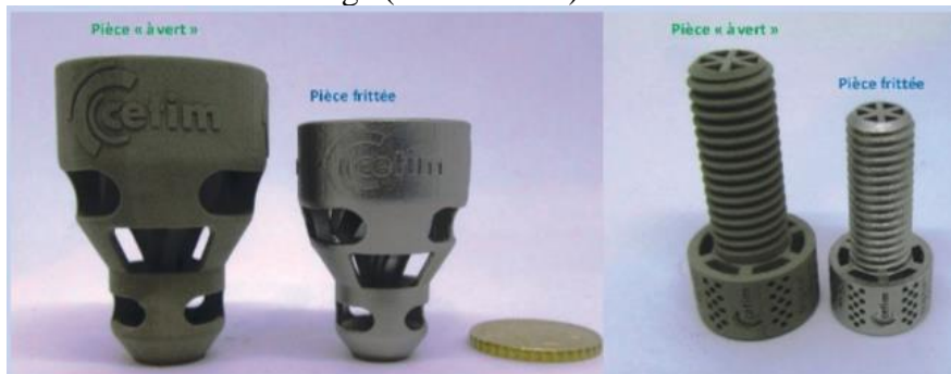
Figure 33 : Exemples de pièces réalisées par MBJ avant et après frittage
