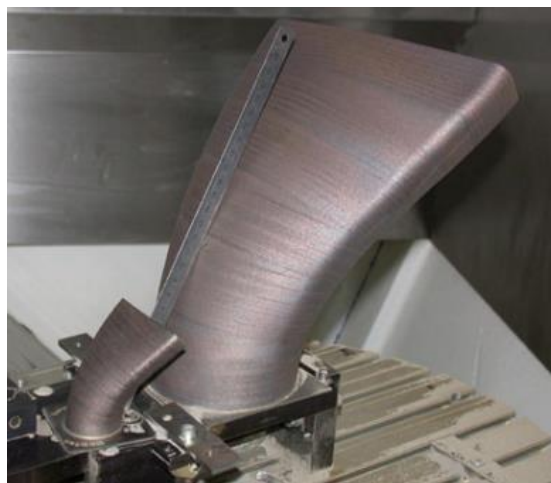
Figure 20 : Conduits aéronautiques obtenus par projection de poudres (Le Bourhis, 2014)
