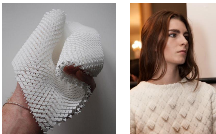
Figure 36 : Vêtement imprimé en SLS. Source : news.softpedia.com/
