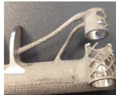
Destruction de la pièce lors du post-traitement par usinage. Adapté de
