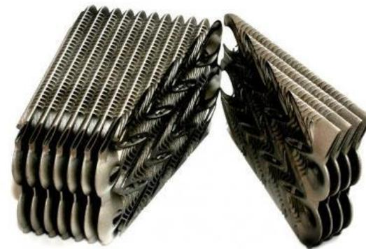
Coupe d'un échangeur thermique
