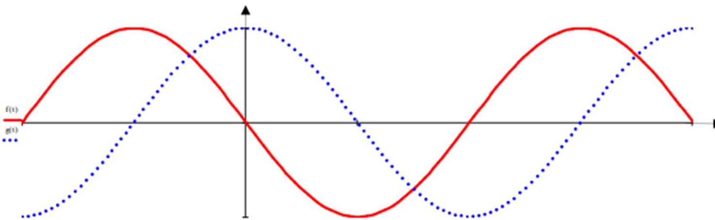
Rappel : La période T est en seconde, la pulsation  $\omega = \frac{2\pi}{T}$  en radian par seconde, et la fréquence  $f = \frac{1}{T} = \frac{\omega}{2\pi}$  en Hertz.
