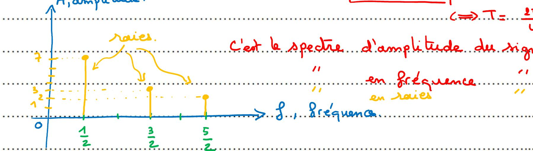
C'est le spectre d'amplitude du signal  $x$
