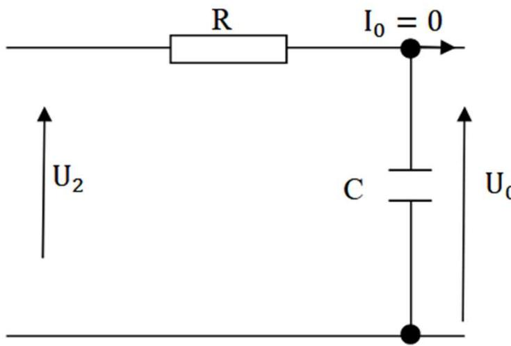
Sa fonction de transfert a pour module :  $T = \frac{1}{\sqrt{1+(RC\omega)^2}} = \left| \frac{U_1}{U_2} \right|$
