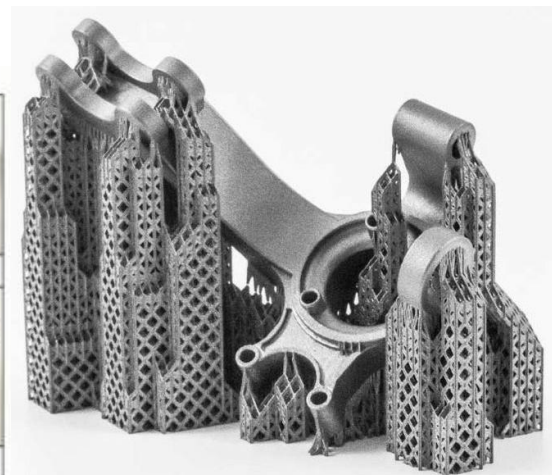
Figure 14. Angles limites (à gauche) ; Supports nécessaires pour la fabrication
