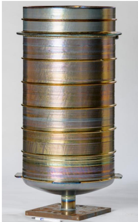
Figure 28 : une cuve de pressurisation de 1 m de haut destinée à l'exploration spatiale, fabriquée en 2017 à l'université de Cranfield pour Thales Alenia Space. La pièce a permis un gain de 80% de matière, 40% de coût et de réduire les délais de 65 % par rapport à l'ancienne méthode de fabrication. (Courtesy Cranfield University and Thales Alenia Space)
