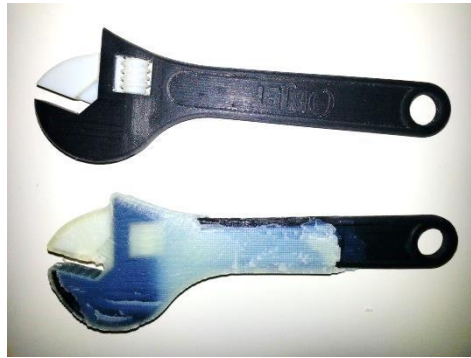
Figure 48 : Exemple d'une clef à molette sans puis avec le support partiellement enlevé à la main
