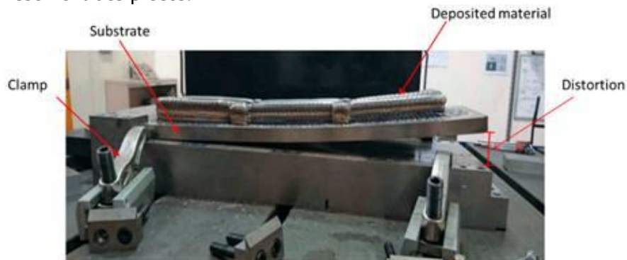
Figure 25 : Problème de gauchissement pour le WAAM (source : metalblog.ctif.com)
