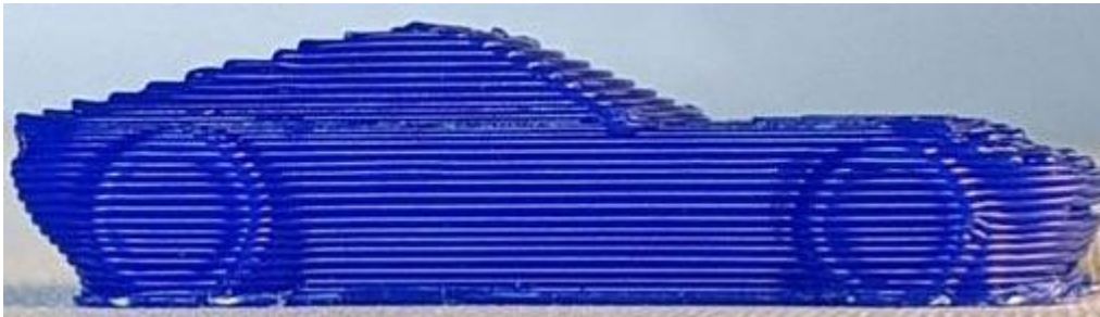
Figure 4 : Exemple de l'effet escalier sur une pièce imprimée par FdM. Source : inria.fr
