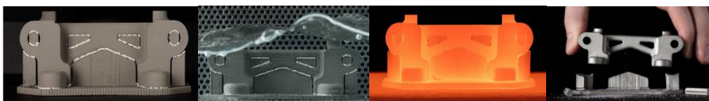
Figure 30 : Etapes de fabrication du BMD. De gauche à droite, la pièce imprimée appelée pièce verte, phase de déliantage, puis la phase de frittage, élèvement du support et à droite la pièce finit
