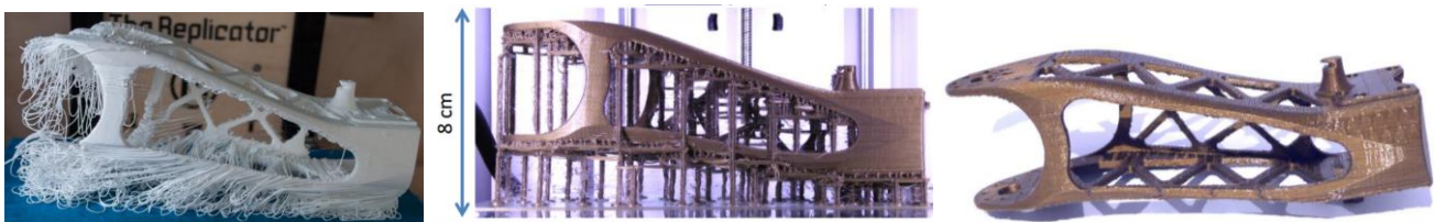
Figure 41 : Exemple de nécessité de support, réalisation de la pièce. Source : (Lefebvre 2015)
