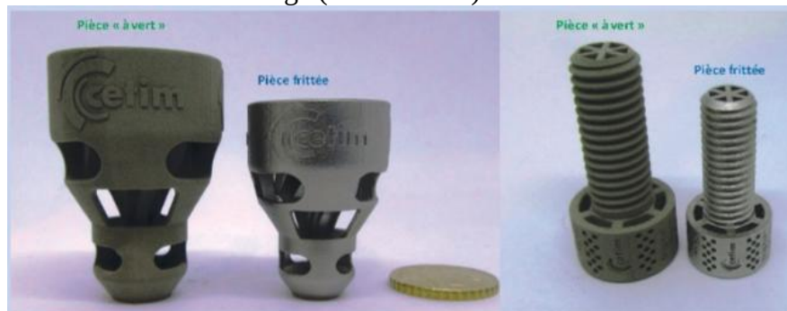
Figure 36 : Exemples de pièces réalisées par MBJ avant et après frittage
