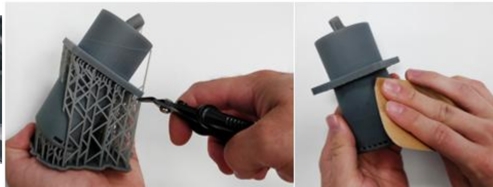
Exemple pour la technologie L-PBF : Enlèvement du support, usinage et traitement de surface
