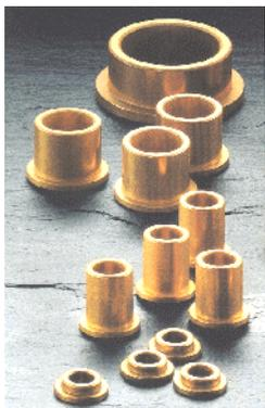
Ils sont fabriqués à partir de poudre de bronze (cuivre 78% + étain 22%) ou d'alliage ferreux (fer + cuivre + plomb) compactées. Ces poudres sont dans un premier temps comprimées dans un moule puis chauffées dans un four pour obtenir des pièces poreuses. Cette opération de fabrication s'appelle le **frittage**.
