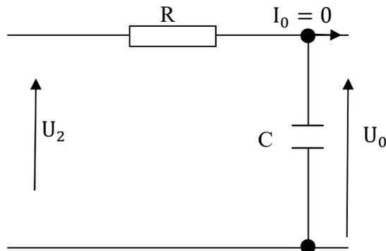
Sa fonction de transfert a pour module :  $T = \frac{1}{\sqrt{1+(RC\omega)^2}} = \left| \frac{U_1}{U_2} \right|$
