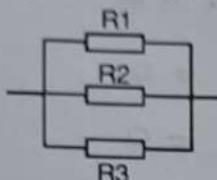
$$\begin{aligned}\frac{1}{R_e} &= \frac{R_1 + R_2}{R_1 R_2} + \frac{1}{R_3} \\ &= \frac{(R_1 + R_2) R_3}{R_1 R_2 R_3} + \frac{R_1 R_2}{R_1 R_2 R_3} \cdot \frac{1}{R_3} \\ \frac{1}{R_e} &= \frac{R_1 R_3 + R_2 R_3 + R_1 R_2}{R_1 R_2 R_3}\end{aligned}$$
