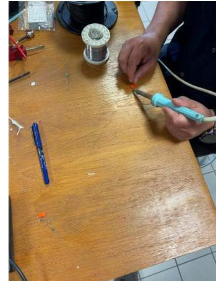
Circuit RRC passe-bas :  $R=82 \Omega$   $C=680\text{nF}$
