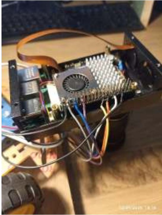
Soudure sur rallonge GPIO
