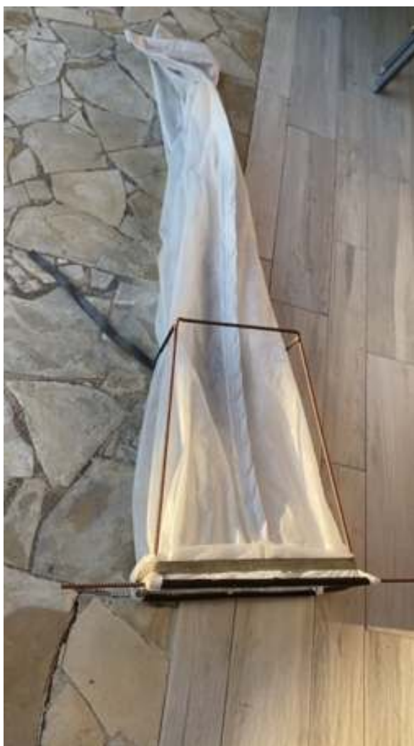
FIGURE 1 – Armature du Filet vue de dessus
